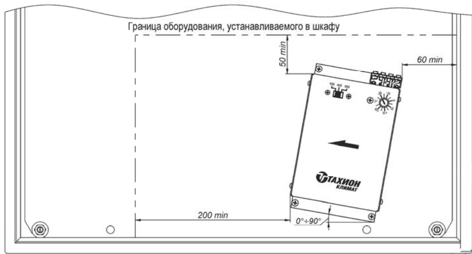
Рис.2 Пример установки на монтажной панели шкафа
